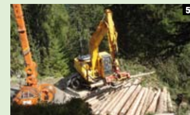
Bild 5: Kostengünstige Holzernte mit Mobilseilkran und Prozessor
